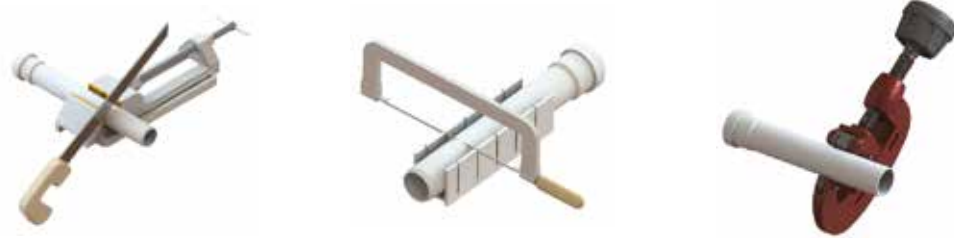
Şekil 12. VESBO INCOLA SBS Boruların Kesilmesi
